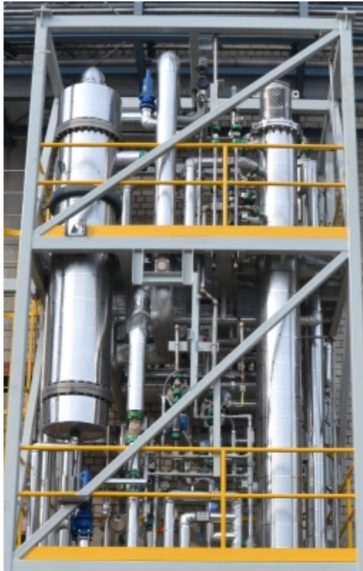
Abbildung 10: Gegenstrom-Extraktion der Firma AVA Biochem zur Gewinnung von HMF aus der wässrigen Produktlösung. (Bild: AVA Biochem)
