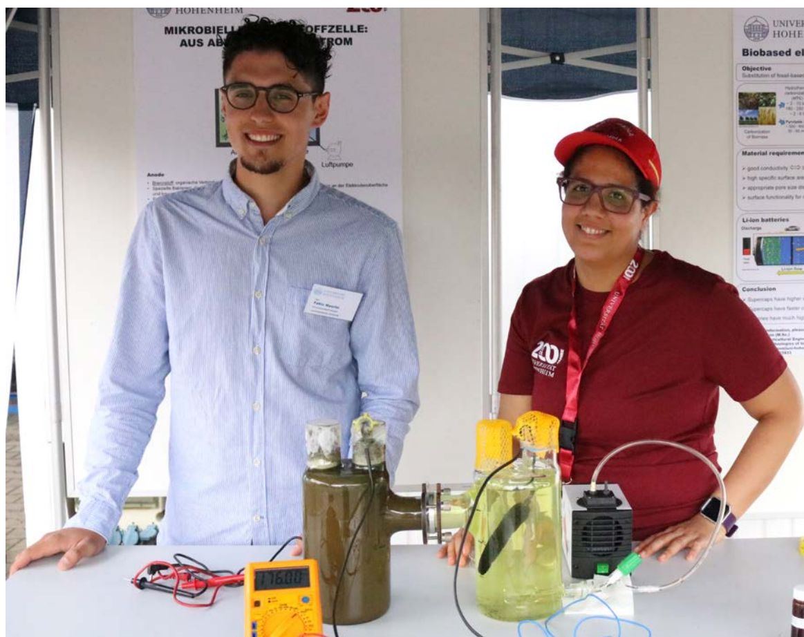
Abbildung 12: Präsentation des Modells einer mikrobiellen Brennstoffzelle beim Tag der offenen Tür 2018. Im rechten Gefäß ist die Elektrode aus einem karbonisierten Maiskolben zu erkennen.
